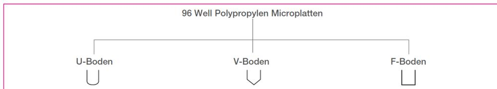
Polypropylen (PP) bindet kaum Biomoleküle, hat eine hohe Temperaturtoleranz und ist gegen viele gebräuchliche Laborchemikalien, wie DMSO, beständig. Von schwarzen Polypropylen Mikroplatten für die Fluoreszenzpolarisation, bis hin zu weissen Mikroplatten für Scintillation Proximity Assays (SPA) ist alles im 96 Well Polypropylen Programm erhältlich.
