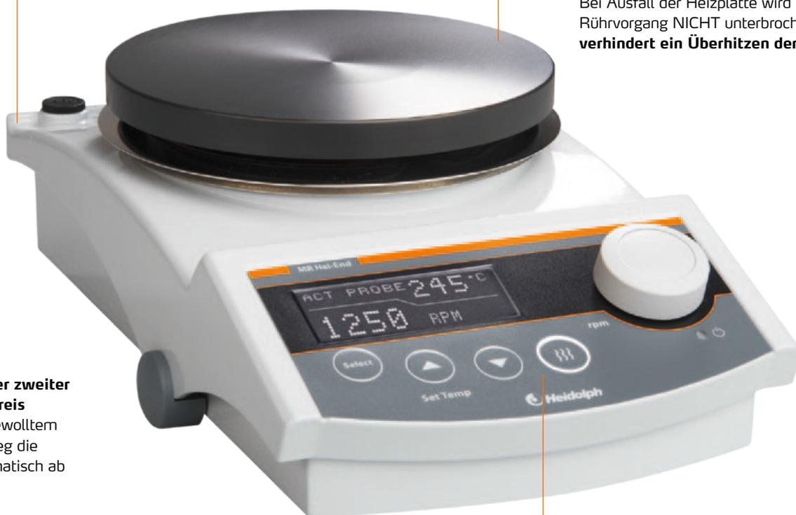
Ein **unabhängiger zweiter Sicherheitskreis** schaltet bei ungewolltem Temperaturanstieg die Heizplatte automatisch ab
