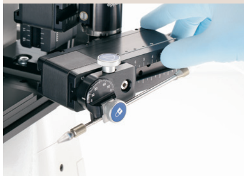
Ausschwenk-Funktion für einfachen Kapillarenwechsel.
