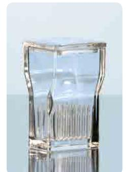
Für 10 Objektträger 76 x 26 mm. Hinweis: Färbekasten und Färbetrog nicht bei Temperaturen über 60 °C reinigen (Glaskorrosion möglich).
