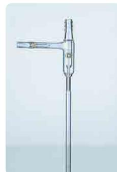
Saugleistung: 400 l/h bei 3,5 bar Wasserdruck und 12 °C Wassertemperatur.
