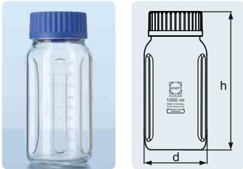
Beim Mischen in DURAN® GLS 80® Laborflaschen entsteht in der Flüssigkeit eine Wirbelbewegung, die der Drehung eines Festkörpers gleicht. Dieses Flussmuster ist sehr ineffizient und erschwert ein gründliches Durchmischen. Die neue DURAN® GLS 80® Weithals-Schikaneflasche verfügt über drei vertikale Schikanen an den Innenwänden, die diese radiale Wirbelbewegung unterbrechen, die vertikale Zirkulation erhöhen und somit eine wesentlich effizientere und homogenere Durchmischung ermöglichen.
