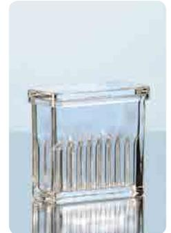
Für 16 Objektträger 76 x 26 mm, mit Erweiterung nach oben. Hinweis: Färbekasten und Färbetrog nicht bei Temperaturen über 60 °C reinigen (Glaskorrosion möglich).
