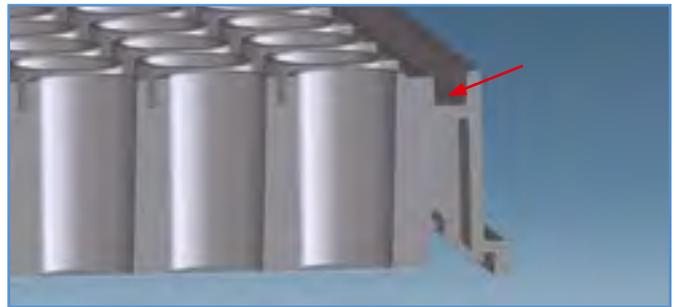
**Abbildung 3:** Umlaufender, mit Flüssigkeit befüllbarer Rand einer 96 Well SCREENSTAR Microplatte reduziert Randeffekte und Verdunstung
