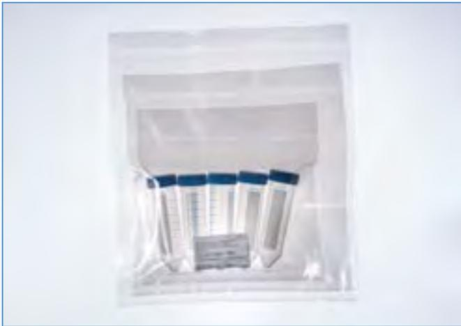
Abbildung 2: Dreifach-verpackte 50ml CELLSTAR® Polypropylen Rührchen
