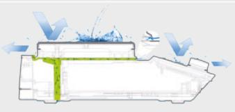
Im Falle eines Überlaufens von Flüssigkeit schützt ein eingebauter Abfluss die Elektronikkomponenten des Geräts.
