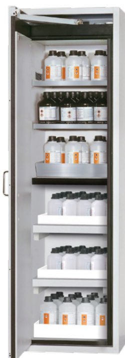
Armoire de sécurité S-CLASSIC-90 modèle S90.196.060.MH.WDAS gris clair (RAL 7035), équipée avec 2 x étagère, 1 x caillebotis, 1 x bac de rétention au sol (acier inoxydable), 2 x étagère de rétention, 1 x bac de rétention au sol (PP) Code article 30353-001-30355 4
