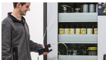
Prise pour le contrôle manuel Surveillance du niveau de saturation du filtre
