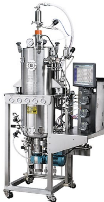
BioFlo® 610 Fermenteur de petite échelle SIP Volume de travail de 13 à 100 L
