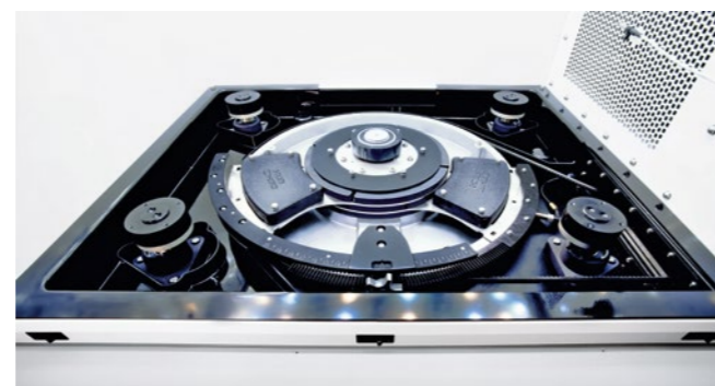
Eppendorf X-Drive avec cinq points de montage excentriques et un contrepoids ajustable qui permet un fonctionnement fiable
